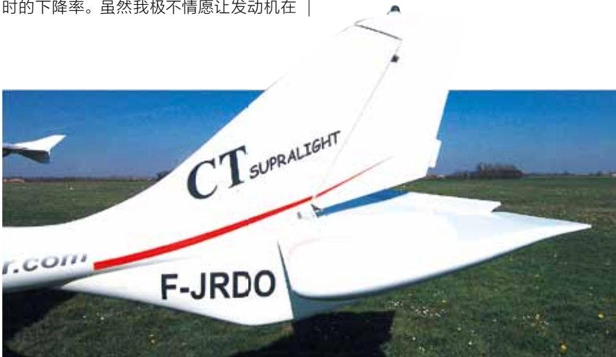
流线型机体，CT 各个机型的飞机尾部设计在不断演变。值得一提的是目前设计中采用的大片垂直尾鳍，这在此前老款机型上是基本没有的。整个尾部呈现出一个平滑的曲线轮廓和一个可调节的凸起的反向气动补偿片
