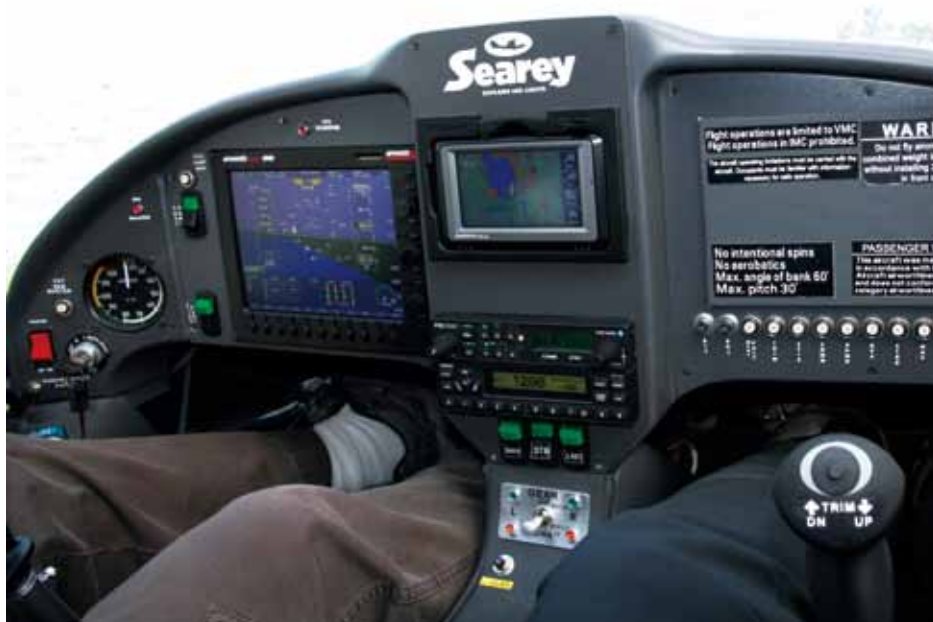
左图：先进的 Microsystem EFIS 监测起落架的位置
