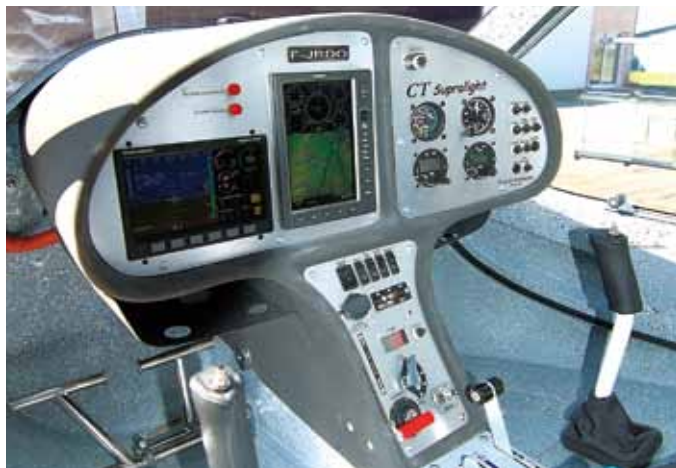
蘑菇形布局的仪表盘,该布局便于扫视所有仪表。左侧是 Dynon DI80 多功能显示屏,右侧是备份的传统指针式的空速表和高度表
