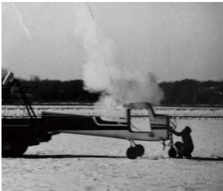
老式赛斯纳 150 飞机机身背部弹射出 BRS 降落伞
