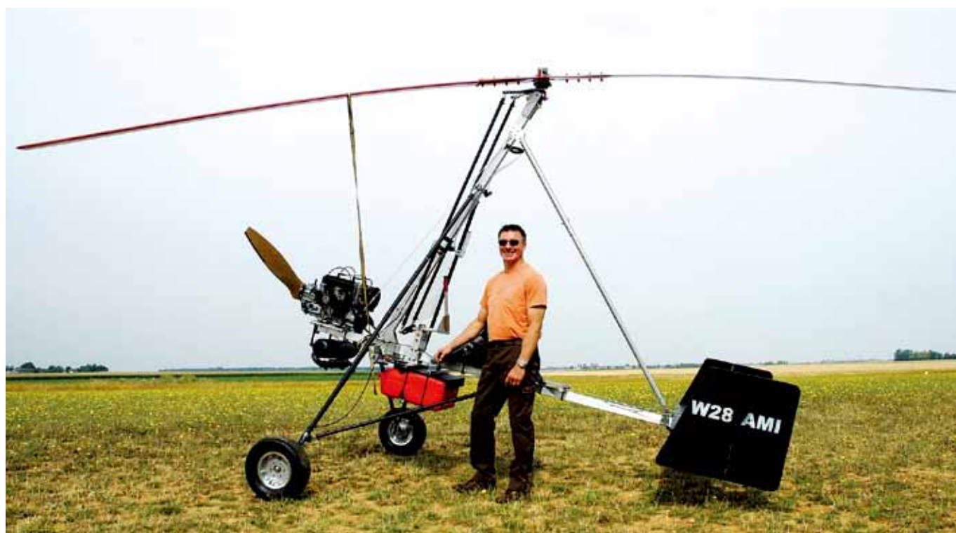
现在仍有旋翼机采用“Bensen”技术，就像有趣设计的 Pascal Olin 旋翼机那样。Olin 采用很少用于旋翼机的牵引机构型。AMI W28 机型装配一台 Rotax503 发动机，一个 7 米长的 McCutchen 转子和尾轮起落架装置
