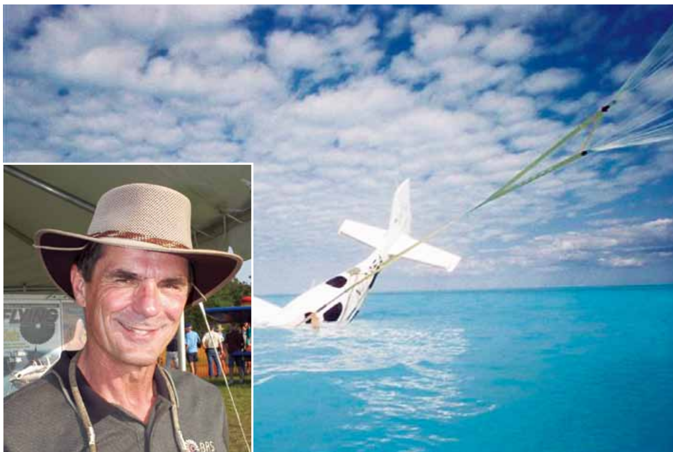
通过 BRS 弹射式降落伞获救的最新案例之一：一架在巴哈马群岛坠落的西锐飞机获救
