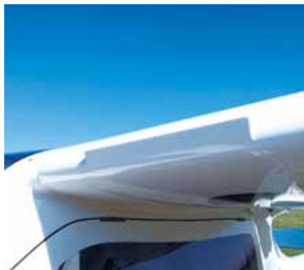
两个小型前缘缝翼能延缓大迎角时流过内侧机翼的气流的分离,防止大迎角下飞机失速
