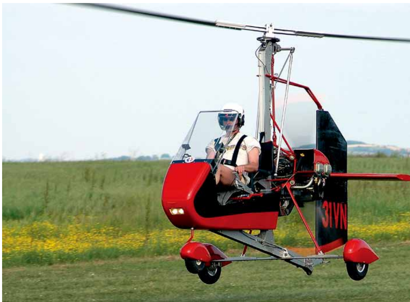
此款旋翼机搭载的是莱康明 O-360 飞机发动机，AirCopter 的转子系统，极具特点，名叫佛罗里达的尾翼
