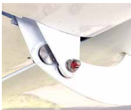
襟翼铰链和副翼插槽。这两个组件被同一操纵杆控制
