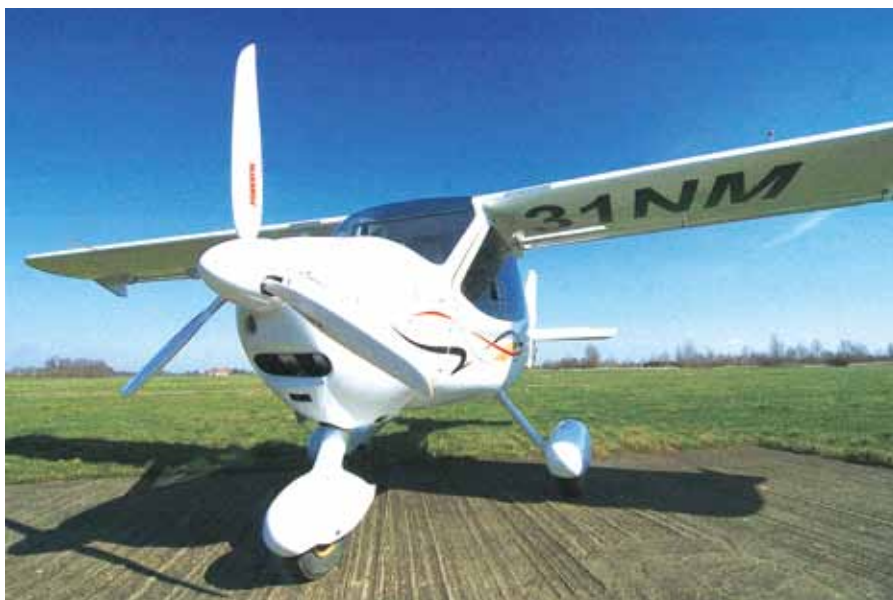
呈现笑脸模样的飞机前脸。CT 飞机较大的机头并没有增大阻力，反而提升了飞机性能
