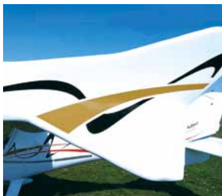
看似空客飞机样式的新型翼尖小翼极大提升了各种飞行状态下机翼的性能
