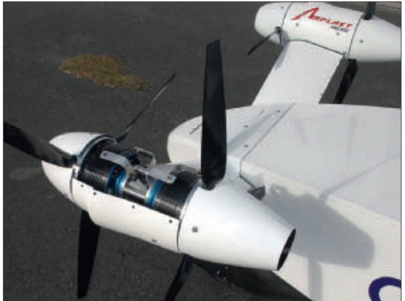
Bei geöffneter Motorverkleidung sieht man die gegenläufig angeordneten e-Motoren, welche an der originalen Motoraufhängung befestigt sind. Auf die Silent-Blöcke konnte wegen des praktisch vibrationsfreien Laufs der e-Motoren verzichtet werden.
