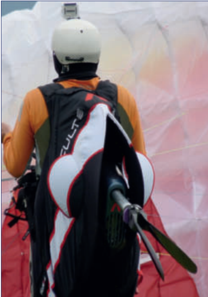
Maximaler Schub: die frei bewegliche Propeller-Achse passt sich automatisch der Position des Piloten an.
