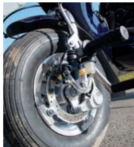
Kleines Detail, das Platz spart: Die Bremsscheibe wurde in die Radfelge verlegt.
