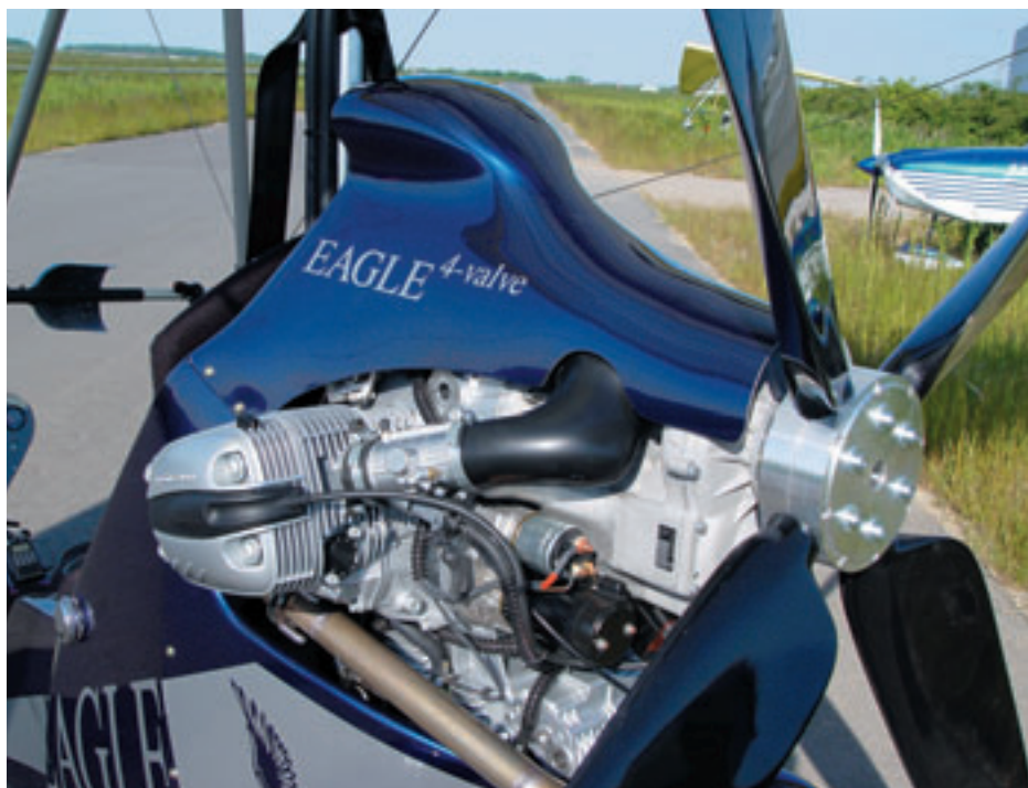
Ein kräftiger BMW-Motor gewährt ordentlich Schub: Er stammt aus der Serienproduktion und wurde hier zusätzlich mit einem Ölkühler versehen.
