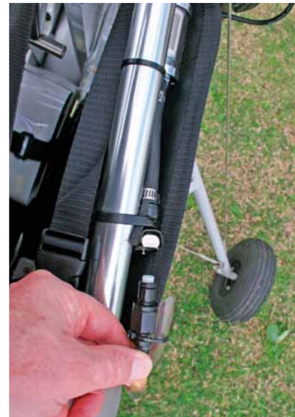
Clic-clac, le réservoir de 10 litres se débranche pour être emporté à la pompe à essence.
