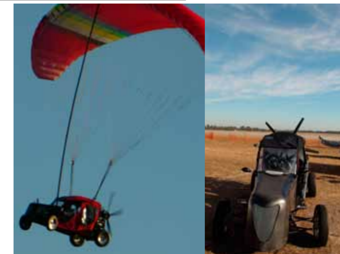
Maverick aus USA - der Stab hält den Schirm vom Boden fern
