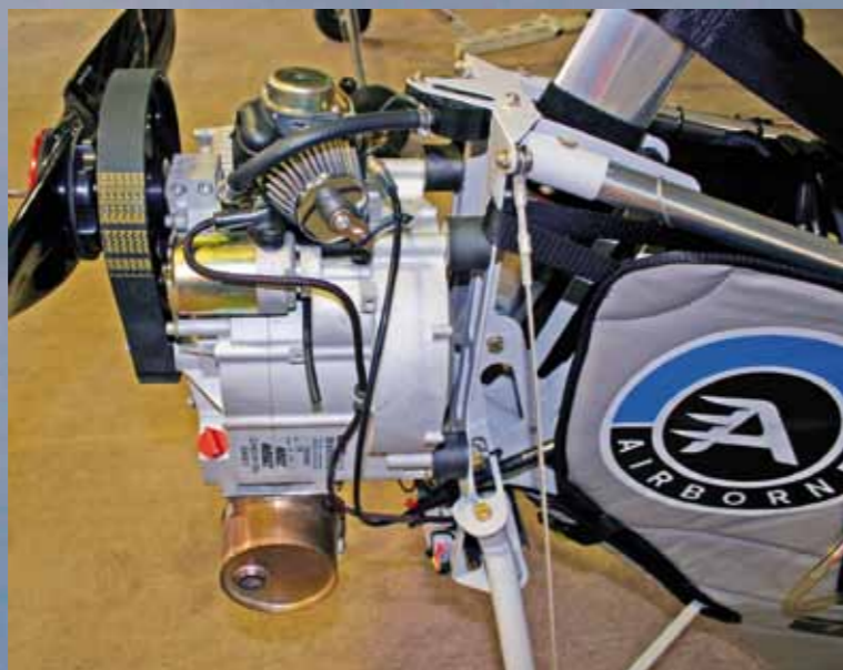
La force du T-Lite est son bloc 4 temps Bailey 4V-200 de 22 ch. Silencieux, fiable et économe, la marque a déjà fait ses preuves dans le monde impitoyable du paramoteur.
