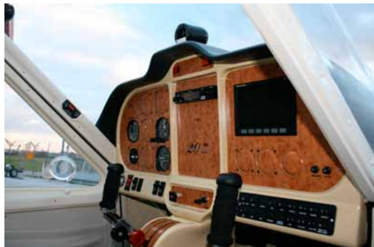
Zum 20. Jubiläum der P 92 wird das klassische Design auch im Cockpit fortgeführt. In der Variante mit dem Lycoming Motor befindet sich Gas - und Gemischhebel auf der Halbrunden Konsole.
