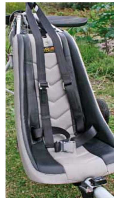
L'assise assez droite est néanmoins très confortable. Le pilote est maintenu par une ceinture 4 points.
