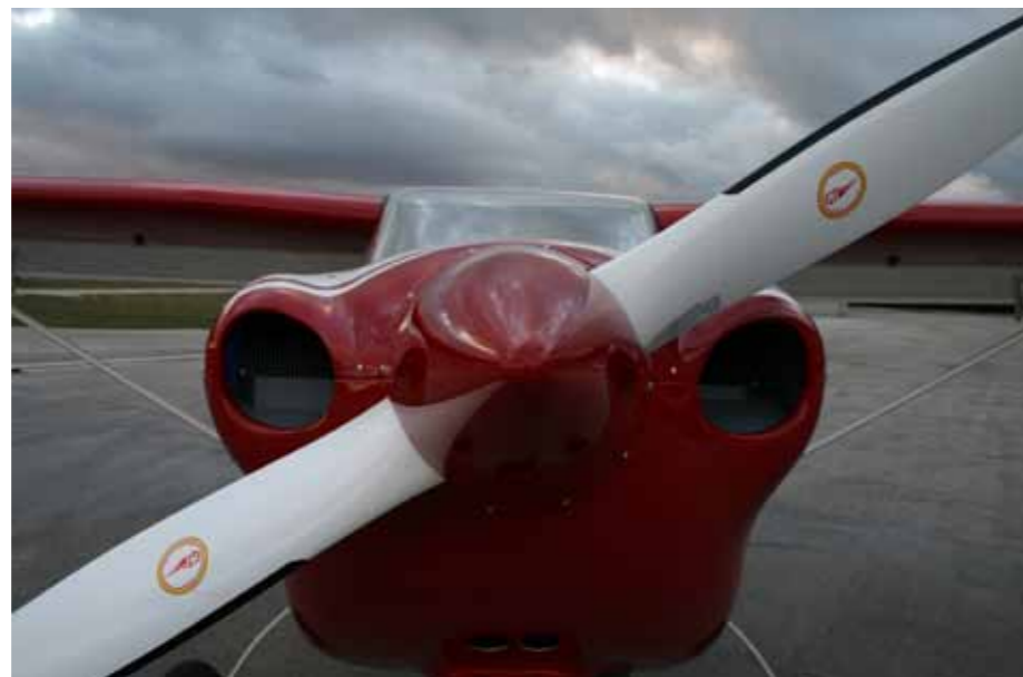
Die größeren Lufteinlässe mit der ausgestellten Couling verleihen der TD einen erwachseneres Auftreten. Der 2 - Blatt Holzpropeller von GT ist auch in Klarlack zu haben. Somit ist die Holzstruktur schön zu sehen.
