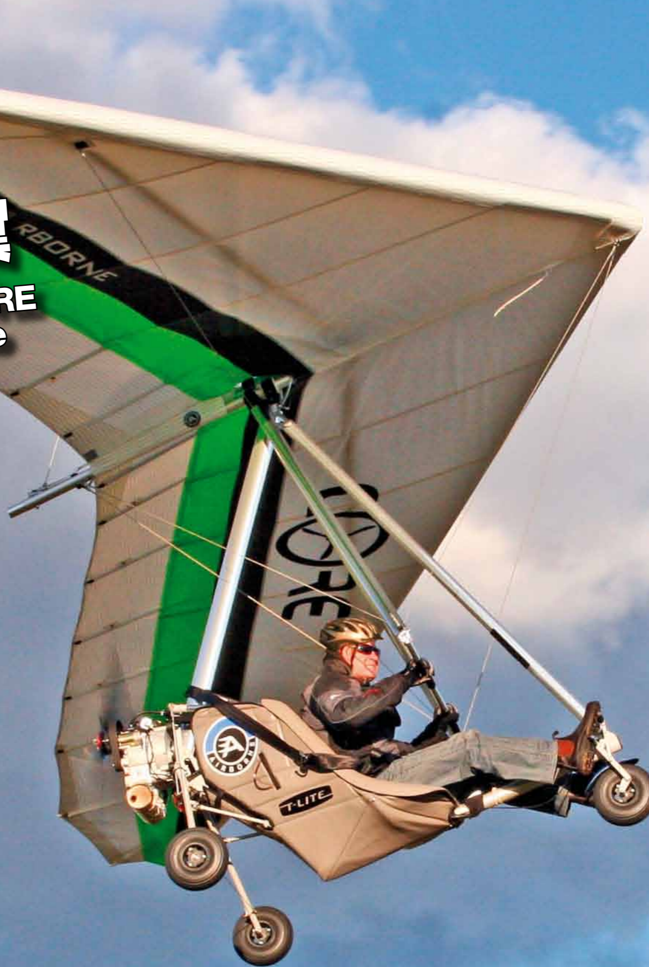
La force du T-Lite est son bloc 4 temps Bailey 4V-200 de 22 ch. Silencieux, fiable et économe, la marque a déjà fait ses preuves dans le monde impitoyable du paramoteur.
